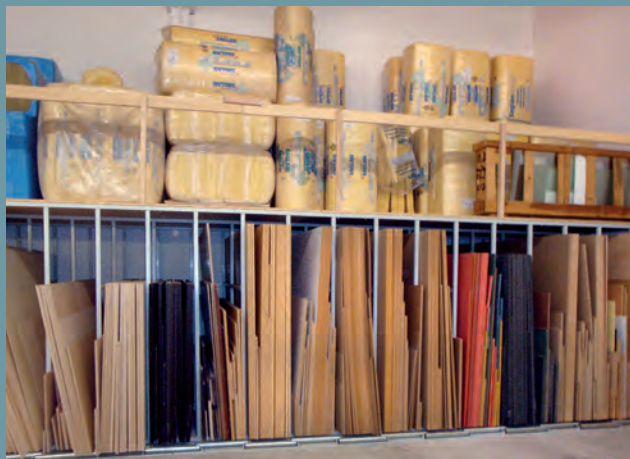
Stockage vertical de panneaux d'aggloméré avec utilisation de l'étagère supérieure comme niveau de stockage supplémentaire.
