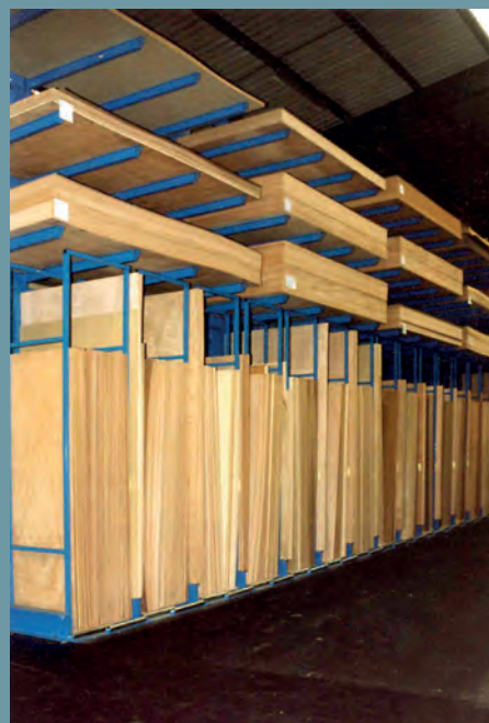
Combinaison de rayonnages à bras portants et rayonnage intégré pour panneaux d'aggloméré. Densité de stockage élevée sur une surface au sol réduite.
