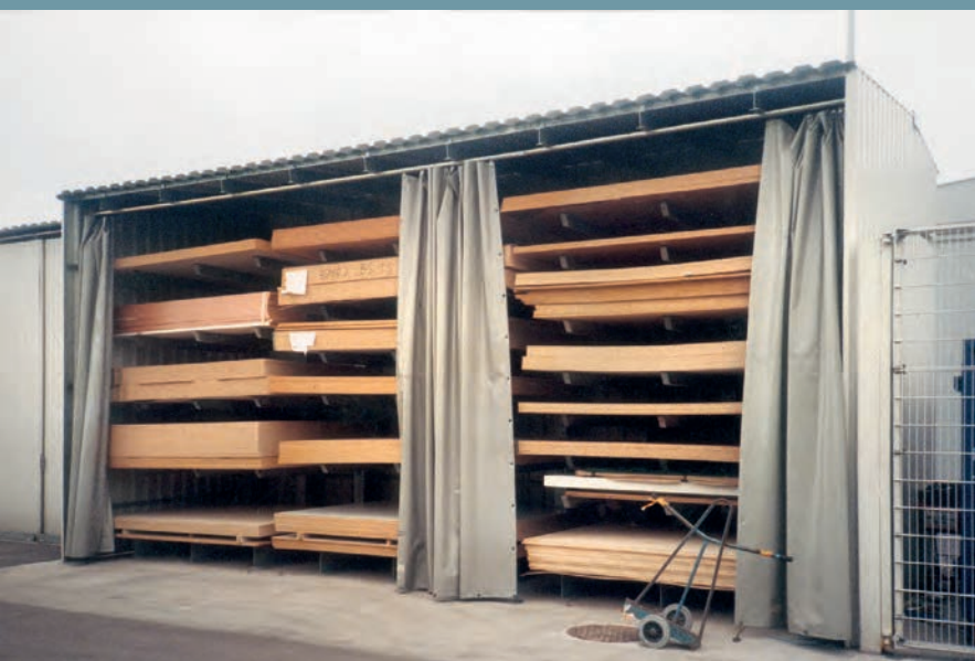
Solution de stockage personnalisée pour panneaux en bois : Rayonnages à bras portant avec toit et murs ainsi qu'un rideau de protection contre la pluie ou la neige, monté sur site.
