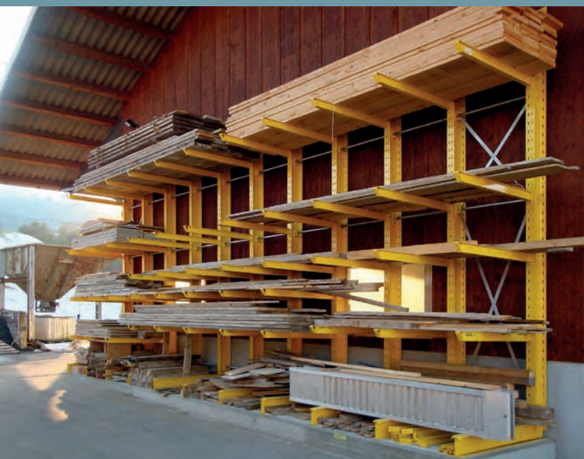
Stockage de longues pièces sous l'avent d'une entreprise de menuiserie. Stockage ordonné et sûr de différents types de matériels et de dimensions dans un système de rayonnage à bras portants.
